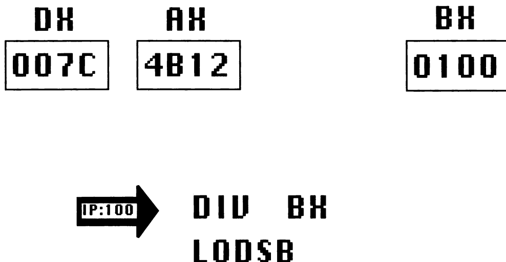
Figura 2-7. Prima dell'esecuzione dell'istruzione DIV. DIV BX calcola DX:AX/BX
