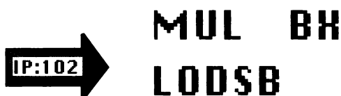
Figura 2-6. Dopo l'esecuzione di MUL. Il risultato è nella coppia di registri DX:AX
